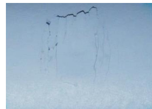
Abbildung 1: FVK mit lackierter Oberfläche und Impaktsschaden (8,5J)
